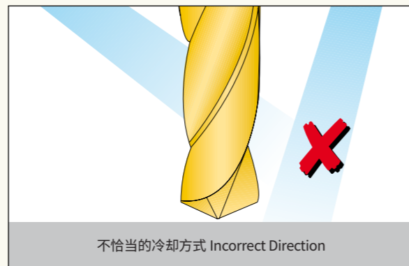
不恰当的冷却方式 Incorrect Direction
