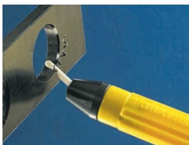
**Инструмент HARD GRATCUT** — идеален для снятия заусенцев с твердых абразивных пластиков.
