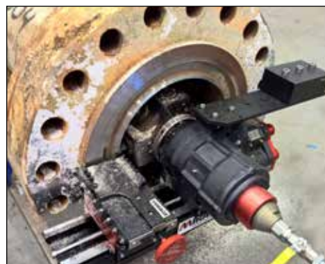
▼ Станок MM860I для обеспечения целостности фланцевого соединения.
