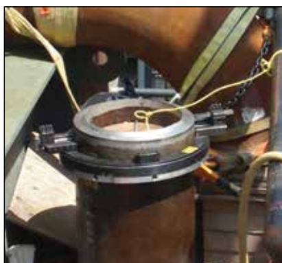
◀ Модель NB — разъемный труборез с узким корпусом.
