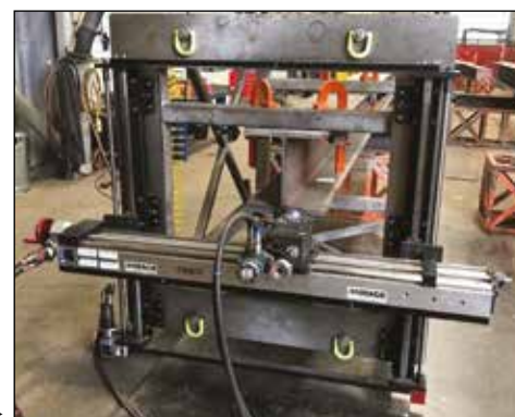
Фрезерование торца двухавровой балки с помощью GMRF1000. ►
