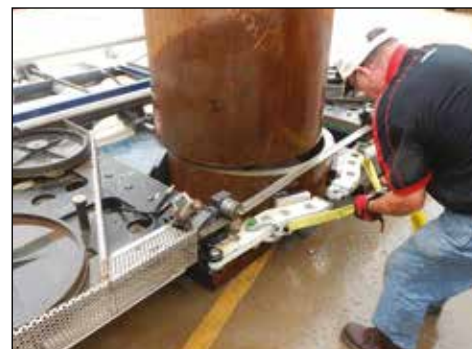
▲ Резание трубы портативной ленточной пилой Mirage BS.
