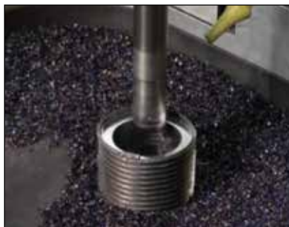
▲ Удаление центра болта (внутренний диаметр резьбы).
