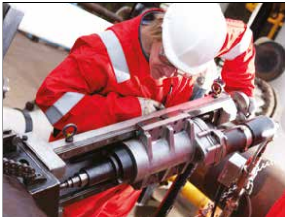
▼ Портативный сверлильный станок HT40.
