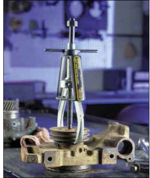
▲ Двухзахватный зажимной съемник EP-204, установленный для снятия ведущего шкива водяного насоса.
