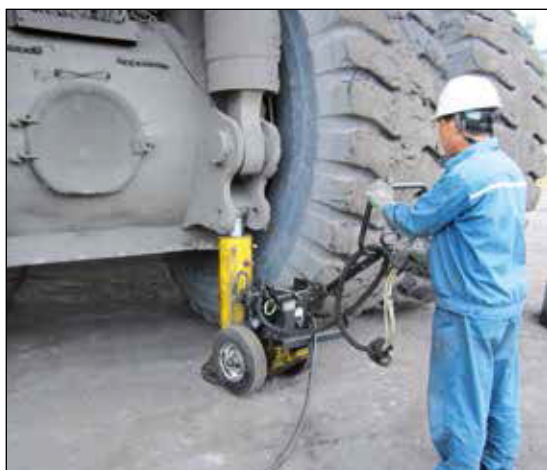
◀ Enerpac Pow'r-Riser® используется в горнодобывающей промышленности для подъема тяжелого оборудования.
