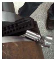
Чтобы облегчить сборку машины в трубе, машина может быть дополнительно оснащена двухсторонним хомутом со съемными удлинителями, чтобы два человека могли свободно устанавливать в обрабатываемую трубу.
