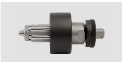
Вальцовки PSE предназначены для выравнивания концов трубы и для увеличения внутреннего диаметра трубы до определенного размера, чтобы создать правильный зазор между наружным диаметром и внутренним диаметром трубы перед пайкой или пайкой серебром. Позволяют соединять трубы того же диаметра между собой без переходников. Доступны до диаметра 203 мм.
