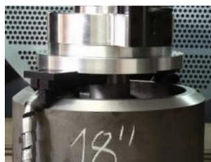
Машина позволяет обрабатывать трубы от ID 4" I.D. до 19" O.D. (101,4 мм I.D. до 500,0 мм O.D.)
