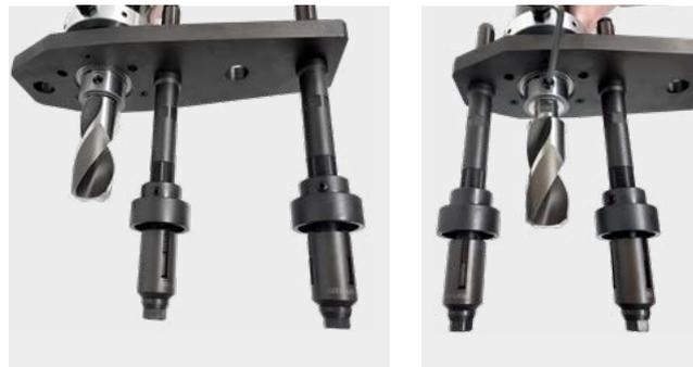
MiniDrill FinFan поставляется с блокирующей плитой и 2-мя реакционными валами. Универсальная конструкция плиты позволяет крепить машину с двумя валами с одной стороны, чтобы можно было обрабатывать последние отверстия в ряду. Плита может поворачиваться на 180 градусов для размещения на перегородках, канальных головках и т.п.
