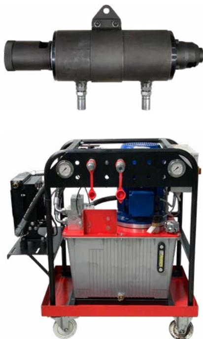
Быстрый и автоматический выдергиватель АСТР-1000 предназначен для удаления труб из конденсаторов и других трубчатых теплообменников. Автоматизация обеспечивает значительную экономию времени, по сравнению с обычными методами. АСТР-1000 - это полностью гидравлическая система - она гарантирует безопасность и устраняет необходимость в электрических проводах между насосом и выдергивателем.
