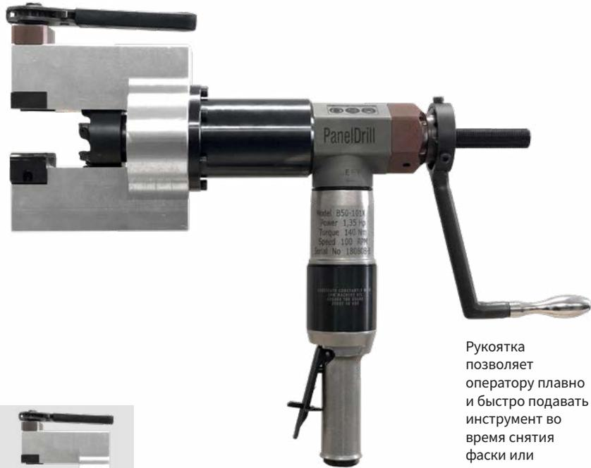
Рукоятка позволяет оператору плавно и быстро подавать инструмент во время снятия фаски или торцевания.
