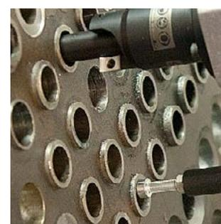
Двухсторонние кулачки и фиксирующая головка обеспечивают непревзойденную эффективность и качество. Механические упоры обеспечивают одинаковую длину выступающих трубок.
