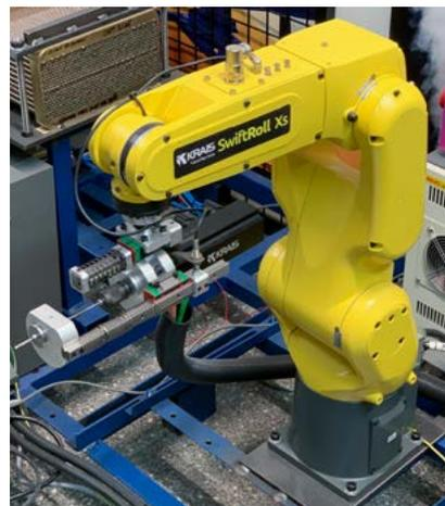
SwiftRoll Xs - уменьшенная версия SwiftRoll X1. Предназначен для небольших производителей охладителей. В этой версии обработка торца трубы недоступна. Доступны приводы до 6000 об/мин.
