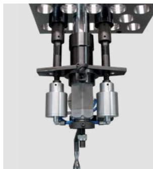
На стандартных теплообменниках машина фиксируется на двух валах на соседних отверстиях. Фиксирующая пластина изготавливается в соответствии с шагом отверстий труб, чтобы обеспечить точное выравнивание инструмента.
