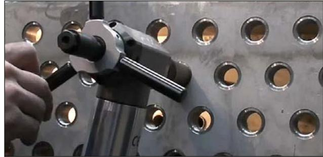
Подрезка труб безопасна и эффективна. Машина надежно фиксируется как на трубке, так и на резьбе пробки водяного бака.
