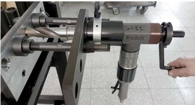
На стандартных газоохладителях FinFan машина фиксируется на двух валах на соседних отверстиях. Фиксирующая плита изготавливается в соответствии с отверстиями трубы, чтобы обеспечить точное выравнивание инструмента.
