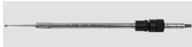
Специальная вальцовка для очень быстрой вальцовки труб в толстых трубных решетках от 6" до 24" без вынимания ее из трубы для перестановки корпуса. Вальцовка имеет пазы расположенные на расстоянии 1" (25,4 мм) вдоль всей длины инструмента и специально сконструированный корпус, который позволяет быстро и эффективно, за несколько секунд, изменить глубину вальцевания. Эта быстрая ступенчатая вальцовка по всей ширине трубной решетки позволяет значительно сэкономить время.
