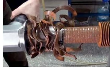
Удаляет оребрение на глубину 4" (101 мм) с наружного диаметра трубы менее чем за 2 минуты.
