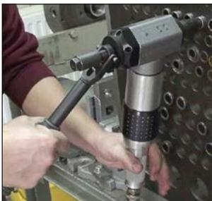
Стандартная система крепления с рукояткой подачи делает обработку концов трубы быстрой.
