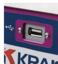
USB-разъем для простого обновления программного обеспечения до последней версии.
