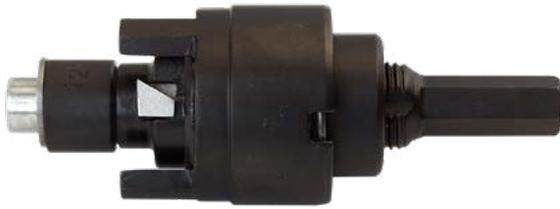
Применяется для торцовки труб теплообменников, конденсаторов и холодильников для получения равномерного выступа 1/3" (3 мм) после вальцовки труб. Подходит для всех электрических и пневматических инструментов, оснащенных патроном 1/2" Jacobs. Инструмент оснащен трехслотовым буртиком для точной регулировки и имеет очень простой механизм замены ножа. Стандартно TEF оснащен шестигранным хвостовиком. Доступен для труб от 10 до 63 мм.
