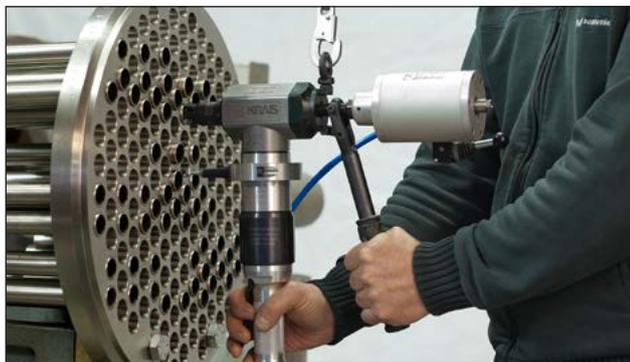
Быстрое крепление в трубе и подача с помощью ручки делают эту систему очень эффективной для производителей теплообменников.
