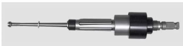
5 роликовая вальцовка с пластиковой направляющей предохраняющей трубы от царапин. Используется обычно для титановых труб.
