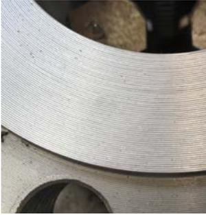
Однолинейная граммофонная канавка (50 канавок на 1 дюйм)
