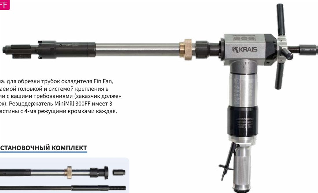
Стандартная машина, для обрезки трубок охладителя Fin Fan, оснащена настраиваемой головкой и системой крепления в трубе, в соответствии с вашими требованиями (заказчик должен предоставить чертеж). Резцедержатель MiniMill 300FF имеет 3 твердосплавные пластины с 4-мя режущими кромками каждая.
