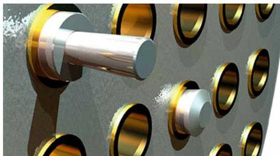
Идеально подходит для герметизации текущих труб в конденсаторах и теплообменниках. Рекомендуется использовать наш однооборотный труборез ORTC, чтобы проколоть трубу, для гарантии, что давление в трубе не может возрасти и вызвать выпадение или выдувание заглушки.
