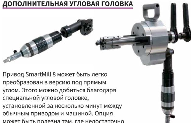
Привод SmartMill 8 может быть легко преобразован в версию под прямым углом. Этого можно добиться благодаря специальной угловой головке, установленной за несколько минут между обычным приводом и машиной. Опция может быть полезна там, где недостаточно места для прямой версии.
