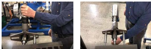
Наиболее удобный вариант может поставляться с реакционной пластиной с двумя фиксирующими валами. Пластина универсальна и позволяет точно выровнять инструмент по шагу труб.
