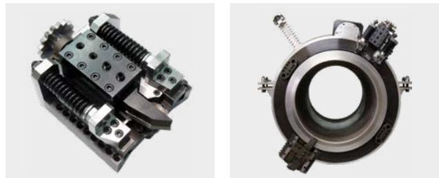
Инструментальный суппорт для некруглых труб - может быть решением для всех деформированных труб и трубопроводов. Суппорт крепится на надежный механизм имеющий прочные пружины и модуль отслеживания, который следует контурам деформированной или не круглой трубы. Создан с тем же качеством: по прочности и долговечности, как и другие инструментальные суппорты KRAIS.
