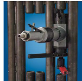
PrepMill с корпусом шириной 66 мм идеально подходит для мест с ограниченным доступом, таких как панели экранов котлов. Легко зажимать и подавать с помощью наших мощных трещоток или штурвалов.
