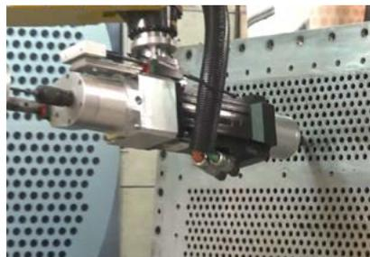
Одновременная обработка двух (!) трубных решеток. Обе они были подготовлены ранее, и теперь они нуждаются в торцовке и вальцовке труб. После часовой настройки все работы выполняются полностью автоматически.
