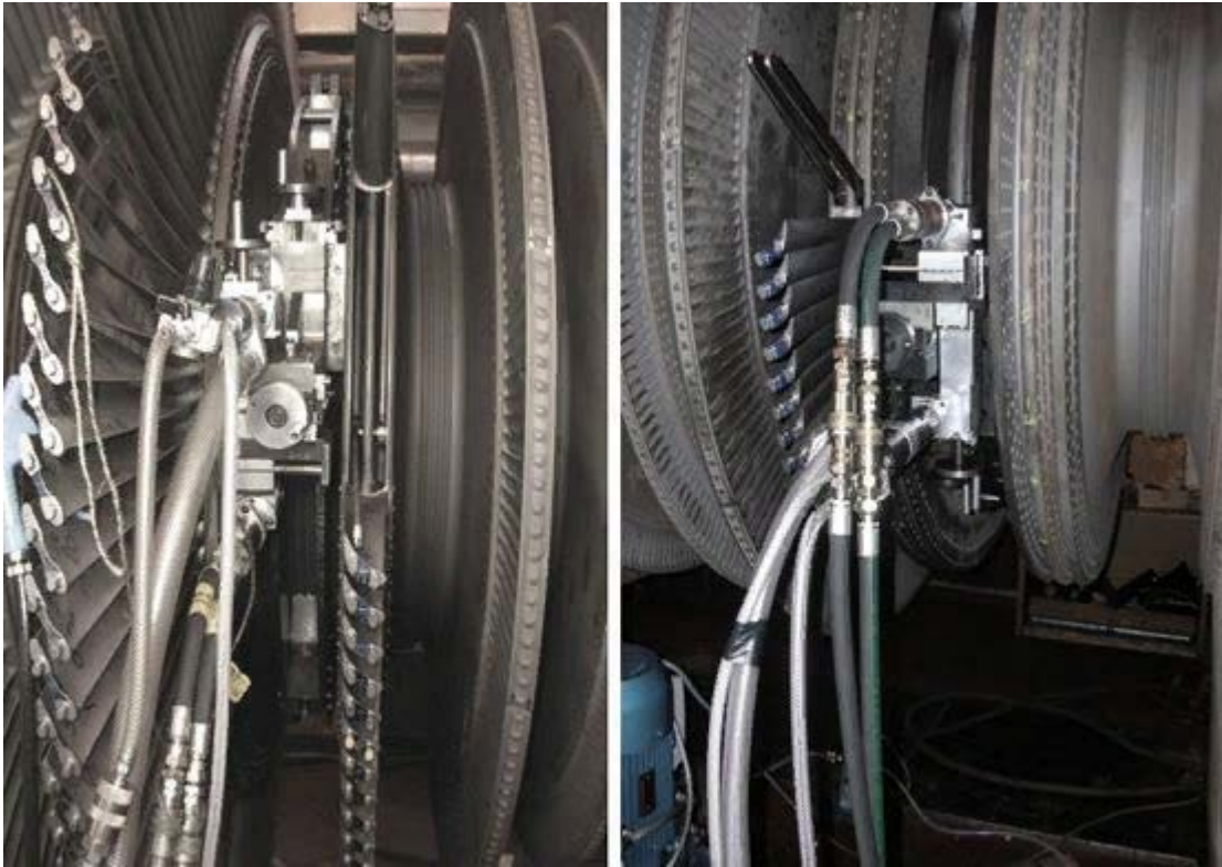
Рис. 2. Специализированные станки для высверливания фиксирующих штифтов лопаток PD760 и для обеспечения точного и эффективного способа вырезки изношенных и поврежденных лопаток BLS760.
