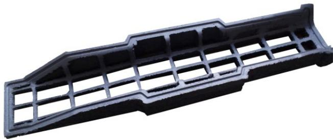
**Рисунок 16.** Вакуумное зажимное приспособление, изготовленное методом 3D-печати.
