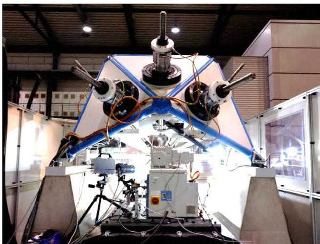
**Рисунок 12.** Технологическая установка на базе 5-ти осевой системы с параллельной кинематикой от компании METROM, экструзионный модуль расположен перед станком.
