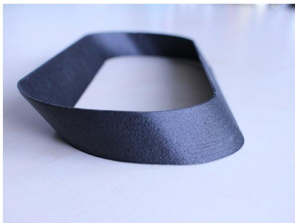
◀ **Рисунок 15.** Экспериментальное изделие с углами свеса до 46°, изготовленное по диагональной схеме.
