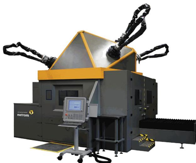
**Рисунок 2.** Металлообрабатывающий станок типа P2030.
