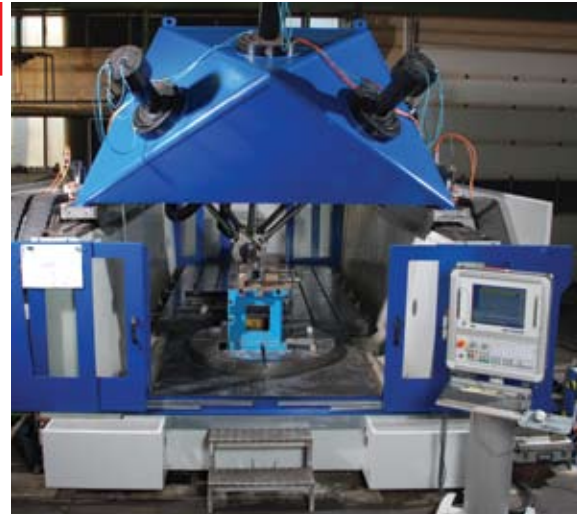
Компактный P1000 для деталей до 1000x1000x600 мм
