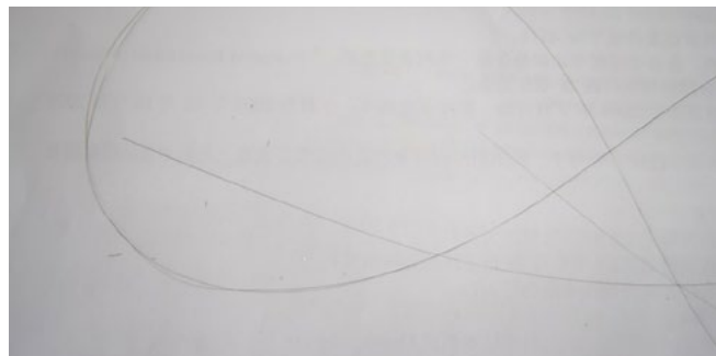
Фото 21. Первичные волокна хорошего качества достаточно однородные, гибкие, диаметр 25–30 мкм.
