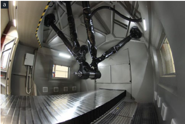
Рисунок 4. а — закрытый бокс для кнопок управления и маховика, дополнительные уплотнения V-оси (стола перемещения), специальные крышки с прокладками для операций технического обслуживания, b — полностью закрытая рабочая зона.
