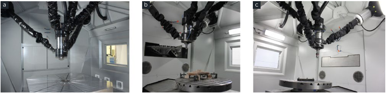
Рисунок 3. а — станция для чистки конуса шпинделя, инструментальной оснастки и инструмента перед его сменой, b, c — герметичное исполнение магазина инструмента.
