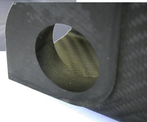
Обработка крышки авиадвигателя из углепластика
