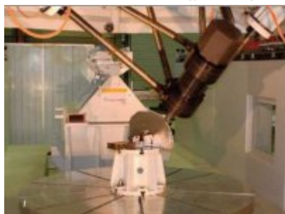
Рис. 1. Метод сварки трением с перемешиванием на обрабатывающем центре METROM
