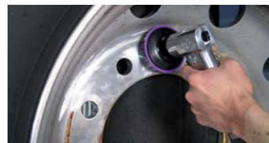
3 – Чистка колес (Полировальная машинка, стр. 52)
