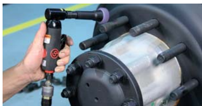
1 – Чистка барабана (Угловая зачистная машинка, стр. 42)
