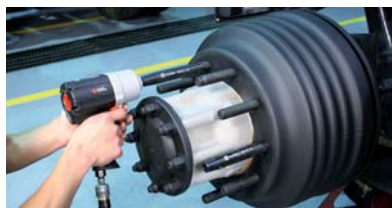
2 – Установка втулок в барабан (Ударный гайковерт, стр. 16)
