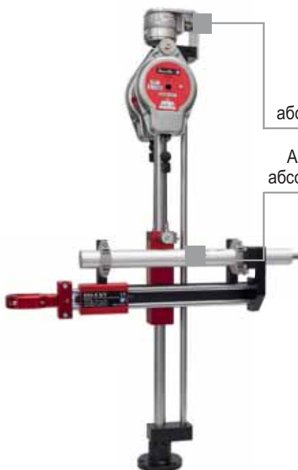
Стойка для инструмента с датчиками положения по осям X и Y
