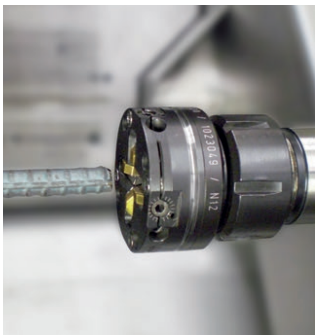
Бесцентровая обточка арматурного прутка головкой FS Barpeeling of rebar with FS head
