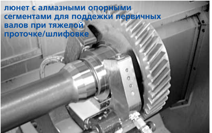
люнет для обработки валов в авиастроении
